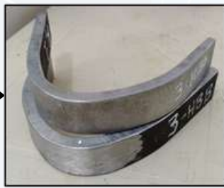
ENSAYO DE DOBLEZ GUIADO
